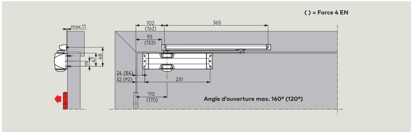
Schéma: exemples sur porte DIN-L. Le schéma serait symétrique sur porte DIN-R.
