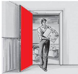
**L'arrêt mécanique n'est pas conçu pour les portes coupe-feu, pare-fumée et pare-flammes. A mettre en place uniquement sur réglage force 3 EN**
