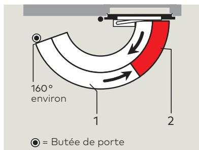
Les réglages hydrauliques sont ajustables en continu par deux vis indépendantes l'une de l'autre.
