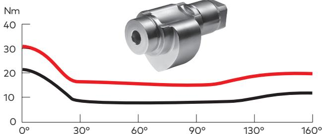
La came symétrique en forme de coeur et l'entraînement linéaire du TS 90 Impulse dormakaba offrent à l'utilisateur un grand confort d'utilisation grâce à une résistance à l'ouverture immédiatement dégressive. Pour les enfants, les personnes âgées et les handicapés, ouvrir la porte est autrement plus facile.
