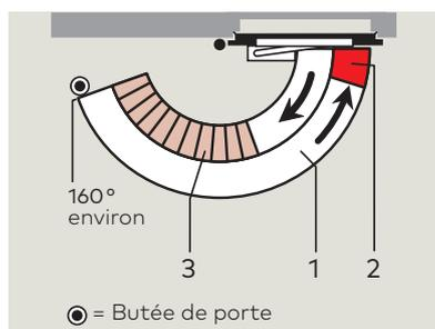
Les réglages hydrauliques sont ajustables en continu par trois vis indépendantes l'une de l'autre.
