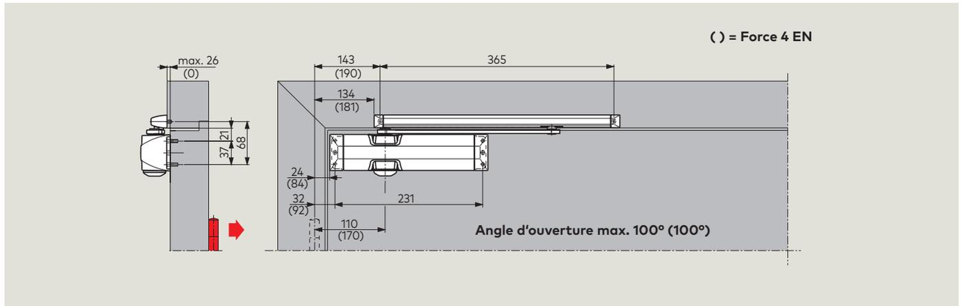
Schéma: exemples sur porte DIN-R. Le schéma serait symétrique sur porte DIN-L.
