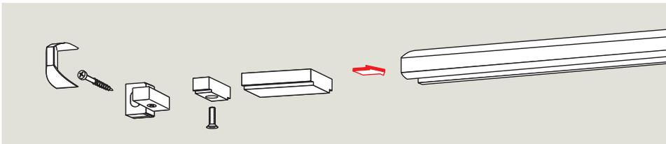
Le limiteur d'ouverture peut être installé dans la glissière ultérieurement.
