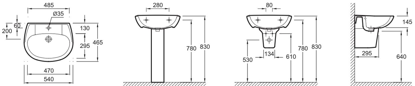
Descriptif CCTP : Lavabo 54 cm. E1282F. Collection : BRIVE. DIMENSIONS : 54 x 46,50 cm. POIDS : 12,9 kg. MATÉRIAU : Céramique. TYPE D'INSTALLATION : Autoportant. FIXATIONS : 3 types de fixations possibles : Goujons, consoles ou crochets. PERCEMENT ROBINETTERIE : 1 trou. CONFIGURATION : Standard. TROP-PLEIN : Avec trou de trop-plein. INFOS COMPLÉMENTAIRES : robinetterie non incluse. OPTIONS : Colonne, cache-siphon.
