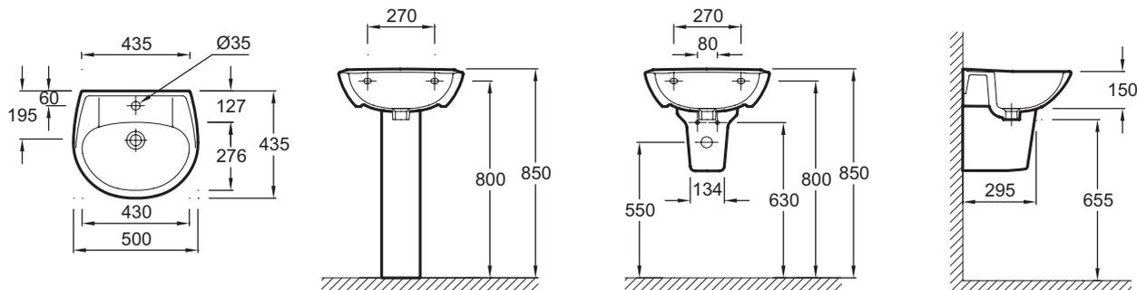
Descriptif CCTP : Lavabo 50 cm. E1345F. Collection : BRIVE. DIMENSIONS : 50 x 43,50 cm. POIDS : 12,5 kg. MATÉRIAU : Céramique. TYPE D'INSTALLATION : Autoportant. FIXATIONS : 3 types de fixations possibles : Goujons, consoles ou crochets. PERCEMENT ROBINETTERIE : 1 trou. CONFIGURATION : Standard. TROP-PLEIN : Avec trou de trop plein. INFOS COMPLÉMENTAIRES : (robinetterie non incluse). OPTIONS : Colonne, cache-siphon.
